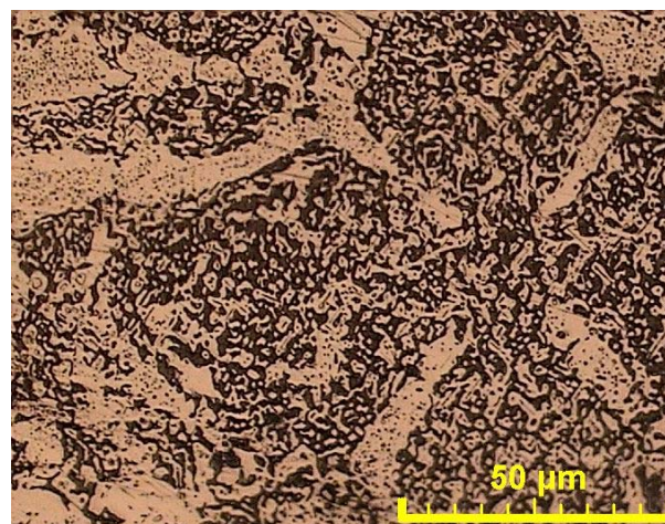
Рис. 4. Микроструктура и химический состав ГЦП(CrAl), полученного по одностадийной технологии (после диффузионного отжига)
