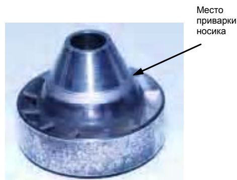
Рис. 4. Завихритель, отремонтированный заменой носика
