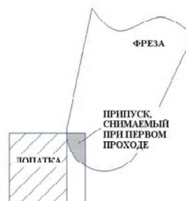
Рис. 12. Схема срезания припуска на первом проходе при спиральной обработке
