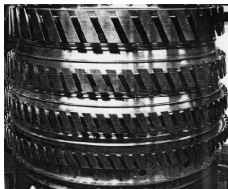
Рис. 5. Барабан 1.....4 ступеней КВД двигателя Д-18Т после ремонта (заменена 2-я ступень)
