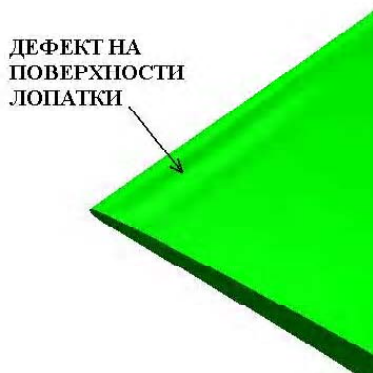
Рис. 6. Дефект поверхности в результате неправильного выравнивания
