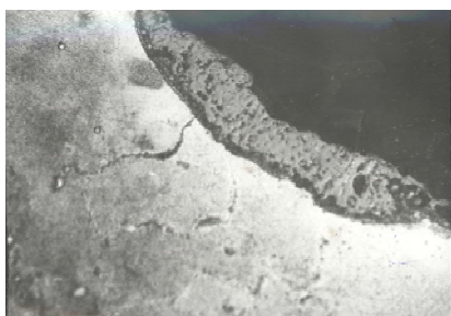
Рис. 5. Внешний вид внутренней полости лопатки после эксплуатации без применения газоциркуляционного хромоалитирования
