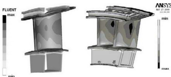
Рис. 8. Поле температуры пера лопатки, по расчету в Fluent и восстановленное в ANSYS
