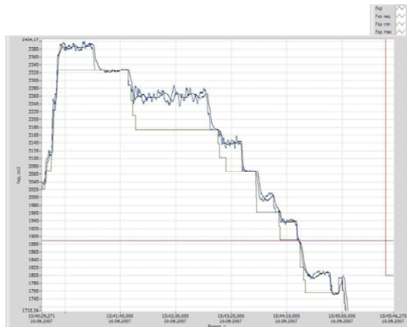
Рис. 14. Снятие программных значений площади критического сечения сопла для площадок дроссельной характеристики ТРДДФ
