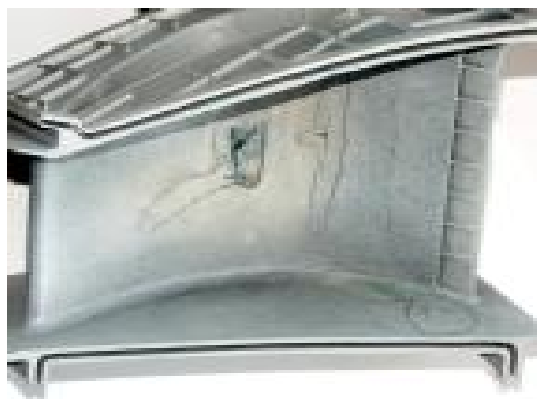
Рис. 1. Внешний вид поврежденной лопатки
