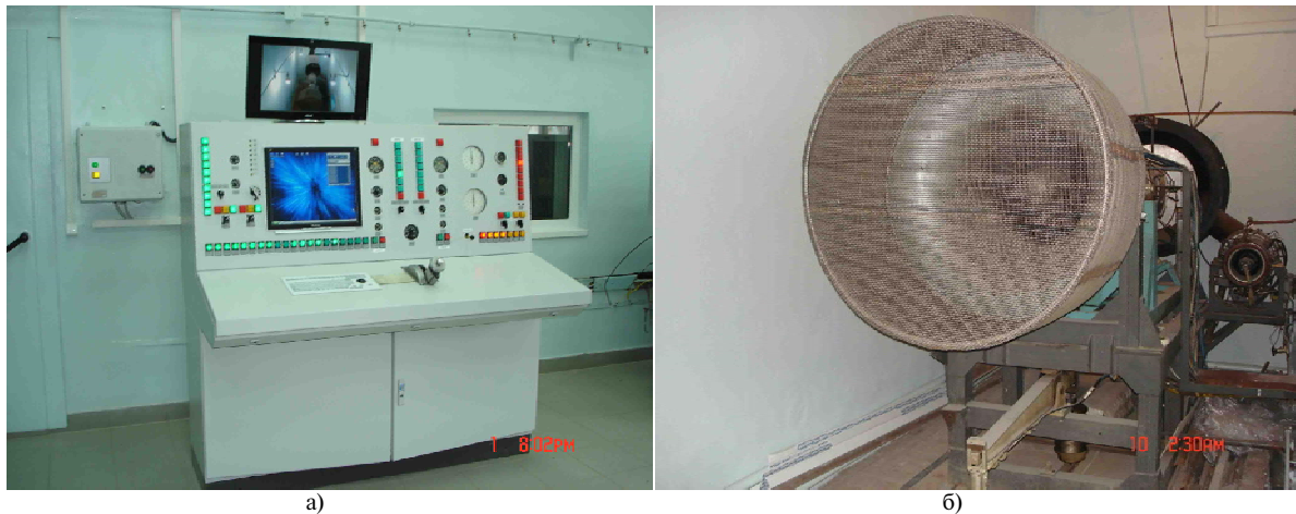
Рис. 2. Пульт управления и ТРДД АИ-25 на автоматизированном учебно-исследовательском стенде
