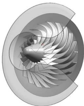
Рис. 2. Проточная часть и трехмерная модель тестовой ступени
