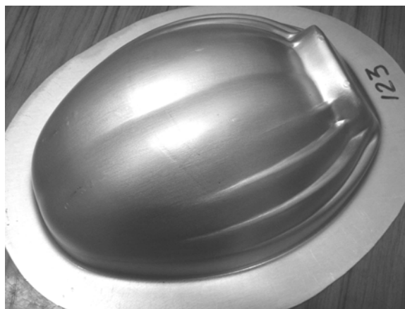
Рис. 4. Слабый отпечаток ступеньки на детали после калибровки
