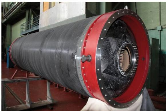
Рис. 2. Корпус из углепластика
