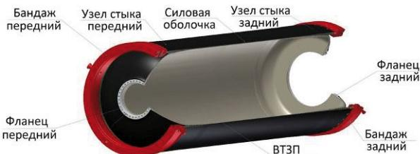
Рис. 1. Конструкция корпуса из углепластика
