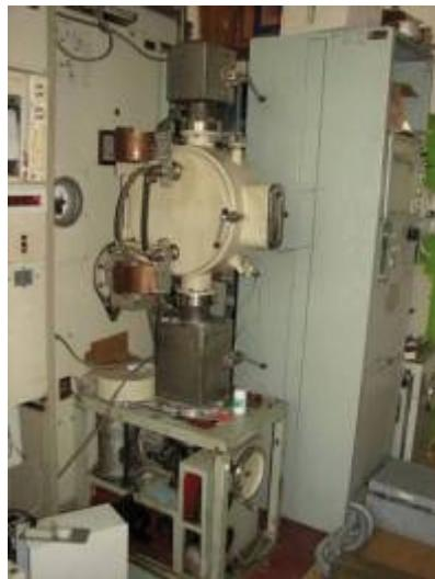
Рис. 9. Оборудование для механических испытаний в вакууме: «NIKON» 1246
