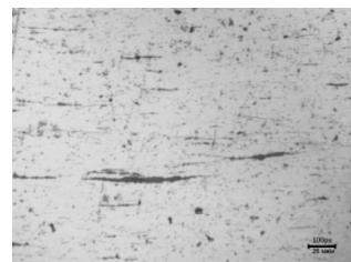
**Рис. 4.** Микроструктура материала, подвергнутого обжатию при прокатке более 30%
