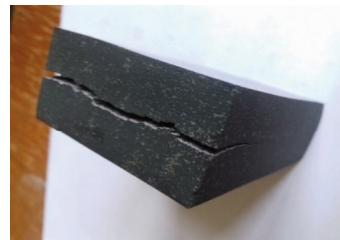
**Рис. 3.** Вид заготовки, подвергнутой обжатию при прокатке более 10%
