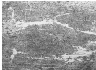
Рис. 15. Микроструктура зоны пайки.
