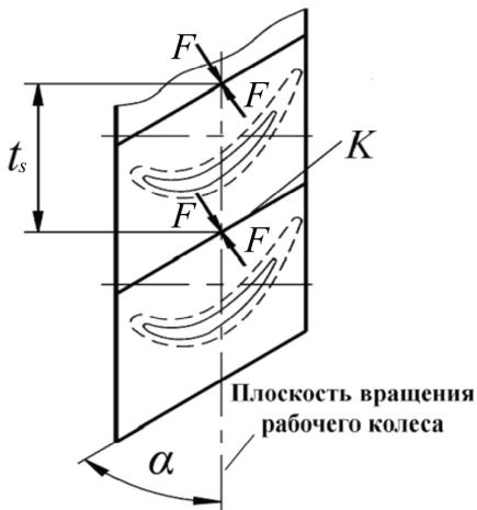
Рис. 1. Схема взаимодействия контактных поверхностей бандажных полок лопаток
