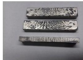
Рис. 12. Поверхность образцов ЮИПМ-NiCr20Ю3 в области пайки при 1300 °C алюминием
