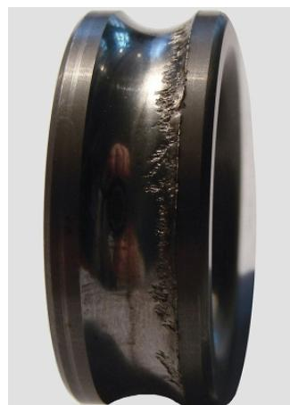
Рис. 4. Следы износа на внутренней обойме
