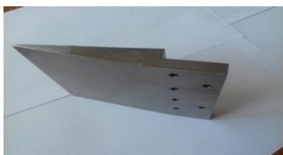
Рис. 11. Макет кромки воздухозаборника из сплава ЮИПМ-NiCr20Ю3
