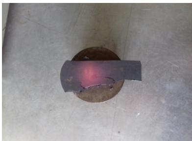
**Рис. 5.** Вид заготовки, подвергнутой обжатию более 10% в процессе горячей прокатки при 1100 °C
