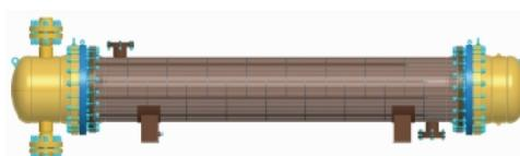
Рис. 3. Общий вид ГМТ на базе биметаллических ребристых труб с БК
