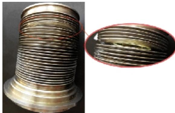
**Рис. 7.** Сильфон после испытаний
