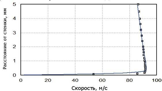
Рис. 8. Профиль скорости для области ламинарного течения ( $s/s_{\max} = 0,2$ ) на стороне разрежения лопатки:
