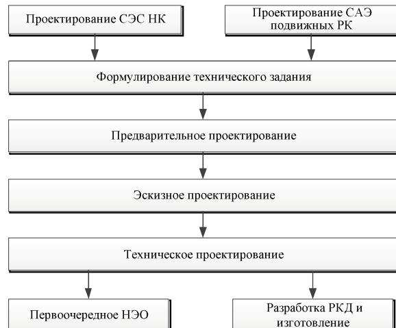
**Рис. 1.** Укрупненная схема процесса проектирования СЭС и САЭ
