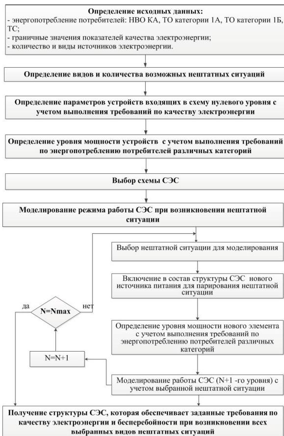
Рис. 2. Алгоритм процесса формирования структуры СЭС с учетом моделирования нештатных ситуаций
