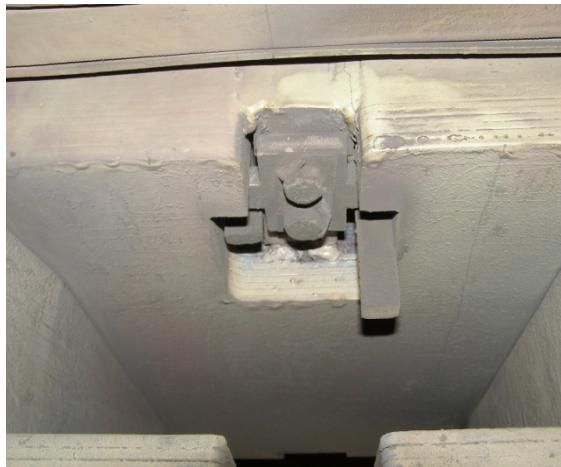
Рис. 2. Упор полюсів генератору
