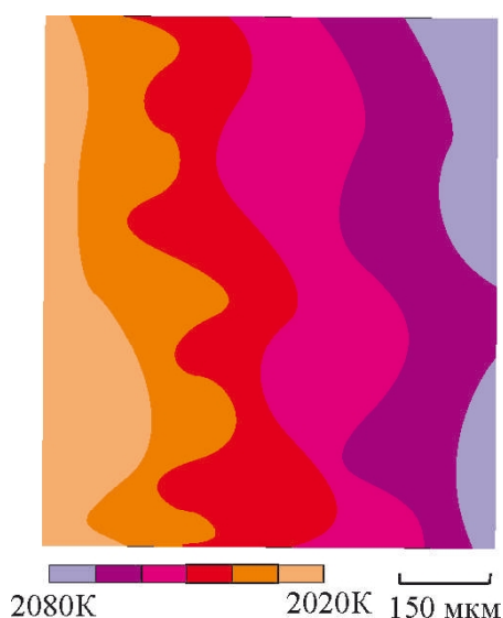
Рис. 9. Температурное поле ( t = 80 мс)
