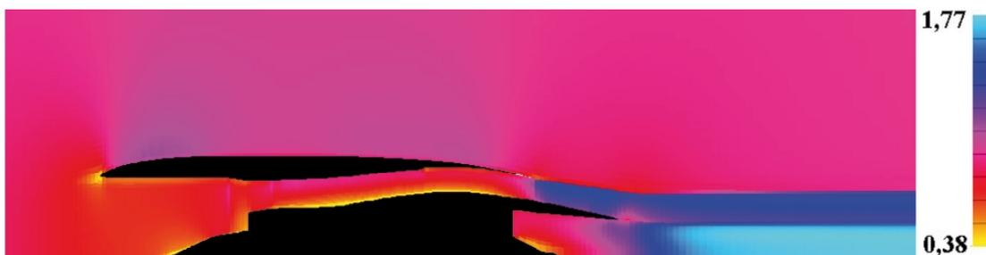
Рис. 6. Распределение продольной составляющей скорости
