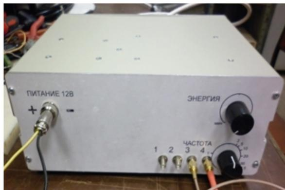
Рис. 2. Генератор наносекундных импульсных разрядов
