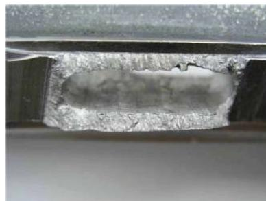
Рис. 14. Поверхность обрыва в среднем сечении разрушенной лопатки
