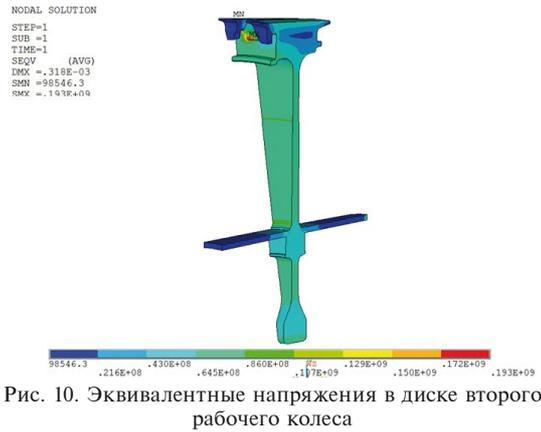
Рис. 10. Эквивалентные напряжения в диске второго рабочего колеса
