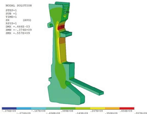
Рис. 13. Эквивалентные напряжения в диске турбины низкого давления
