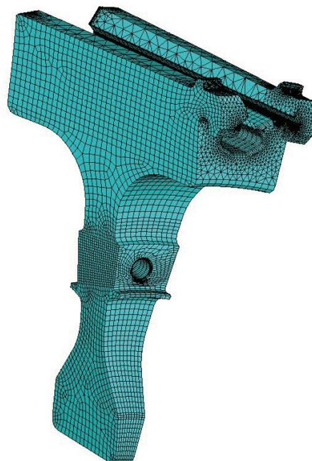
Рис. 7. Конечно-элементная модель диска
