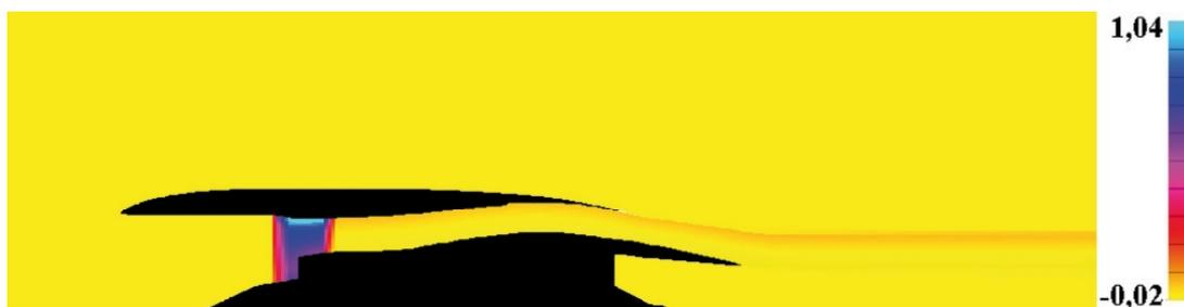
Рис. 7. Распределение окружной составляющей скорости
