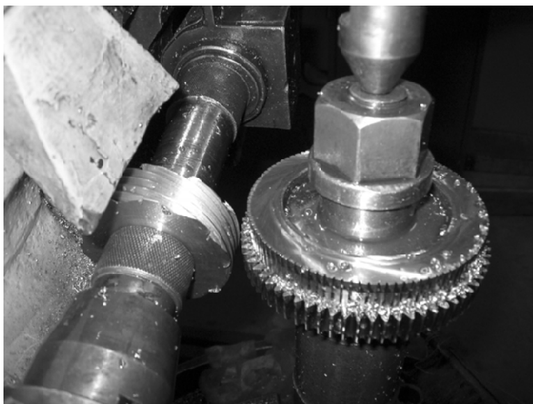
Рис. 2. Изготовление гиперболического накатника при помощи круглого резца и прямоугольного долбяка
