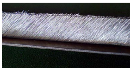
Рис. 1. Щеточное уплотнение ГТД (а), уплотнительный элемент (УЭ) до обработки (б)
