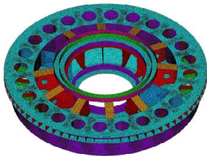
Рис. 4. Общий вид пространственной конструкции крышки гидротурбины
