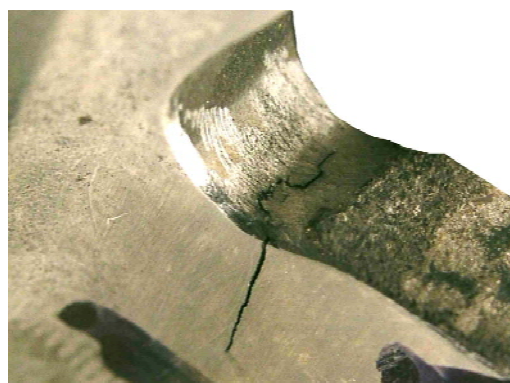
Рис. 4. Трещины, выявленные в зоне хвостовика (а) и антивибрационной полки после раскрытия (б)
