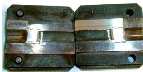
Рис. 2. Разъемная матрица для выдавливания
