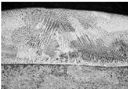
Рис. 1. Микроструктура оплавленного лазером покрытия из ПГ-12Н-01, нанесенного на сталь 38ХНЗМФА, \times 100
