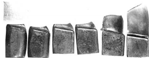
Рис. 7. Заготовки лопаток 5 ступени компрессора, выдавленные с постепенным увеличением длины пера
