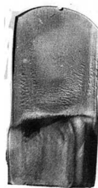
Рис. 14. Заготовка лопатки 4 степени компрессора, выдавленная с покрытием ЭВТ-8
