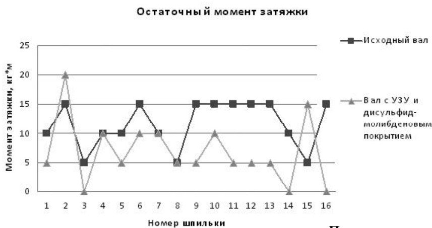
Рис. 3. Остаточный момент затяжки гаек крепления винта после испытаний на выносливость
