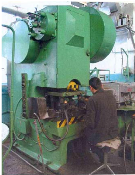
Рис. 3. Пресс и оснастка для выдавливания
