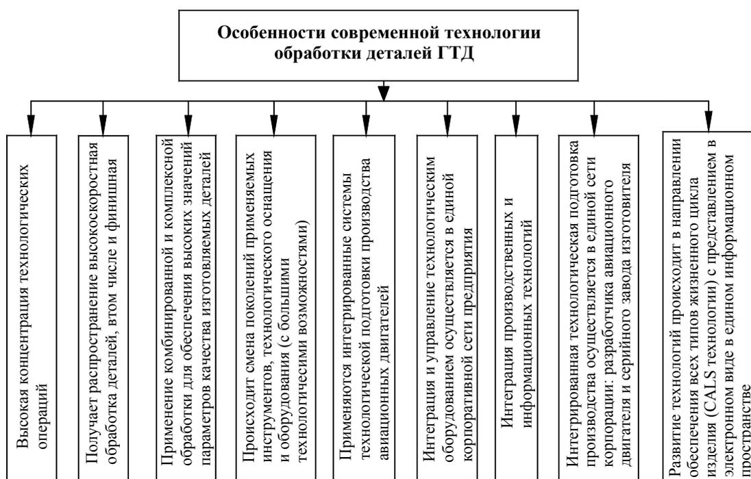
Рис. 4. Особенности современной технологии обработки деталей ГТД
