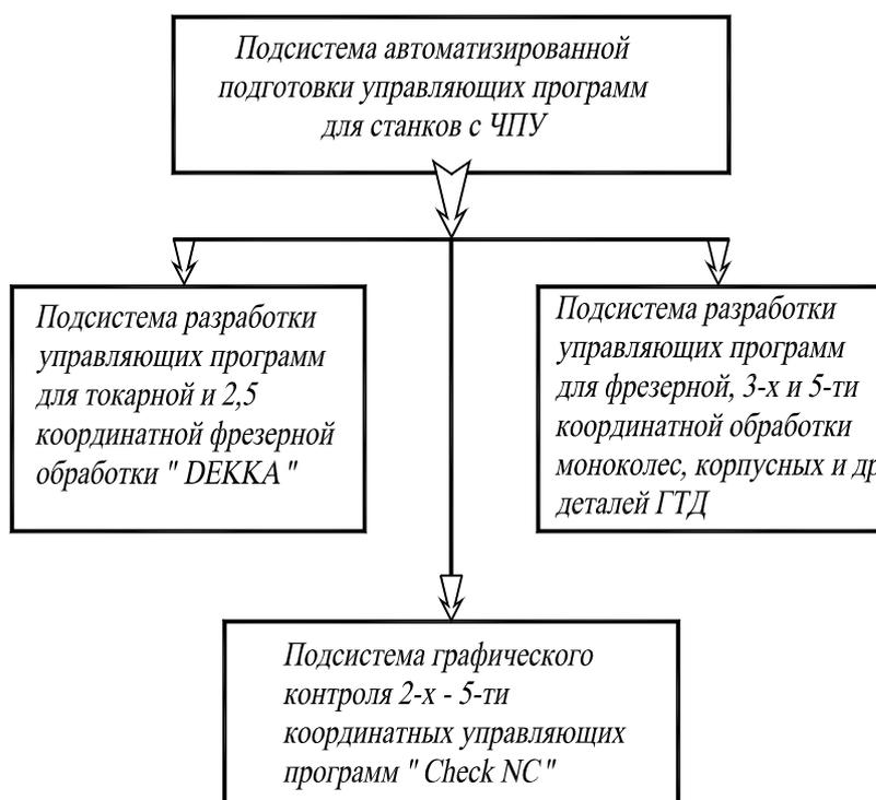
Рис. 4. Структура подсистемы автоматизированной подготовки управляющих программ для станков с ЧПУ
