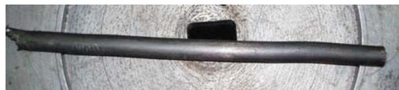
Рис. 3. Титановый пруток, полученный полунепрерывной винтовой экструзией
