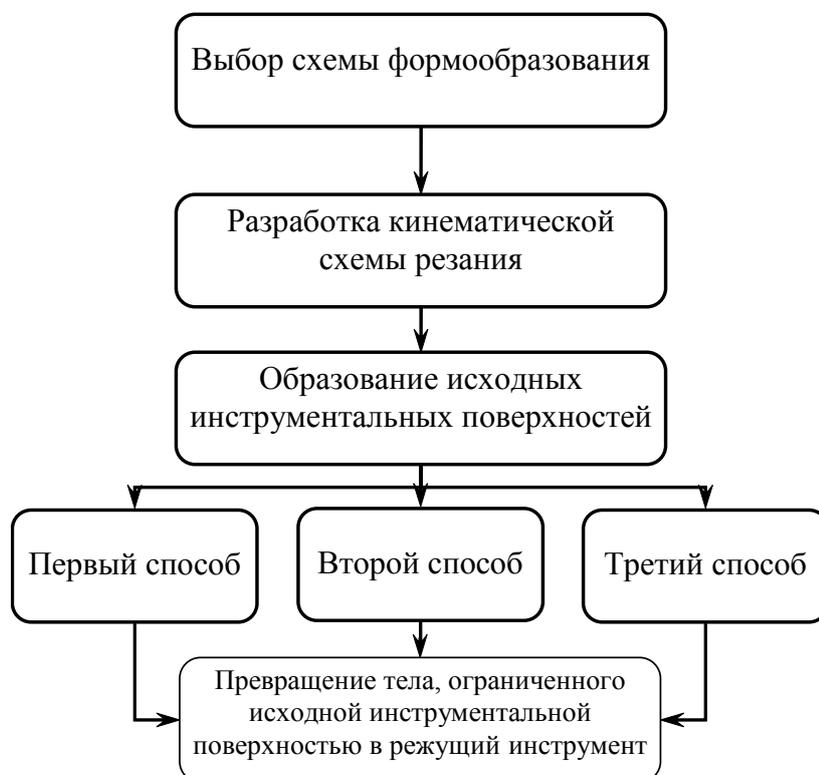
Рис. 1. Схема разработки множества режущих инструментов для изготовления заданной поверхности детали
