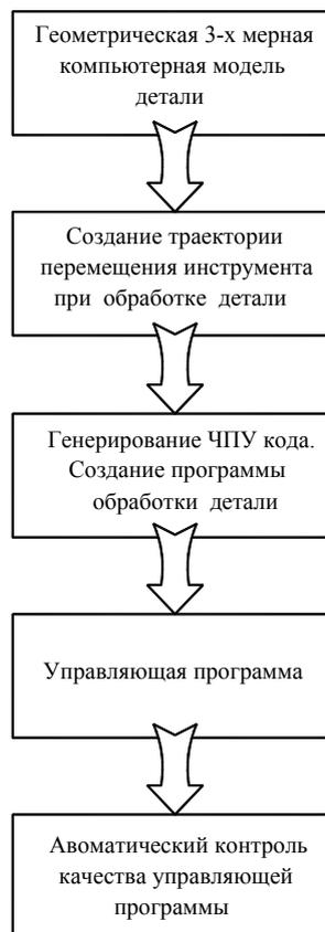
Рис. 15. Структурная схема разработки управляющей программы для станков с ЧПУ
