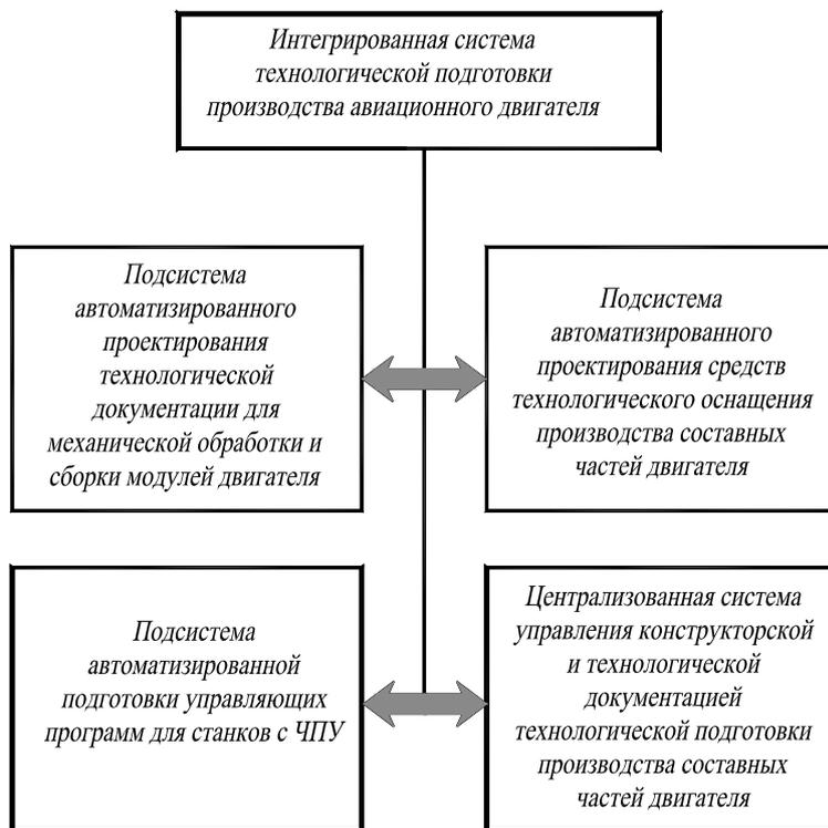
Рис. 1. Структурная схема интегрированной системы ТПП авиационного двигателя
