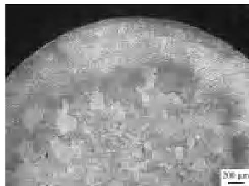
Рис. 4. Фотография поперечного сечения поверхности образца сплава BT22 после усталостных испытаний
