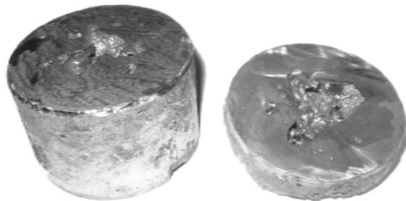
Рис. 4. Газові та усадкові пори у виливку, отриманого плавкою витратного електроду у вакуумно-дуговій печі,  $\times 0,8$
