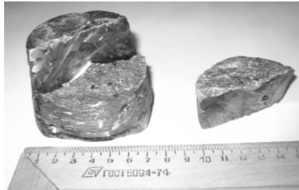
Рис. 3. Газозусадкові раковини і пори у виливку, отриманого електро-дуговим переплавом у атмосфері аргону
