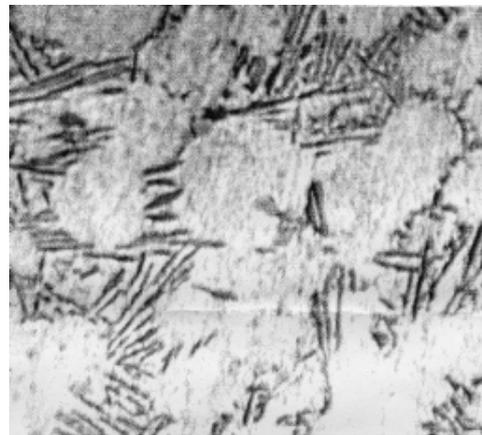
Рис. 2. Микроструктура сплава АЛ4С после модифицирования SiC,  $\times 150$
