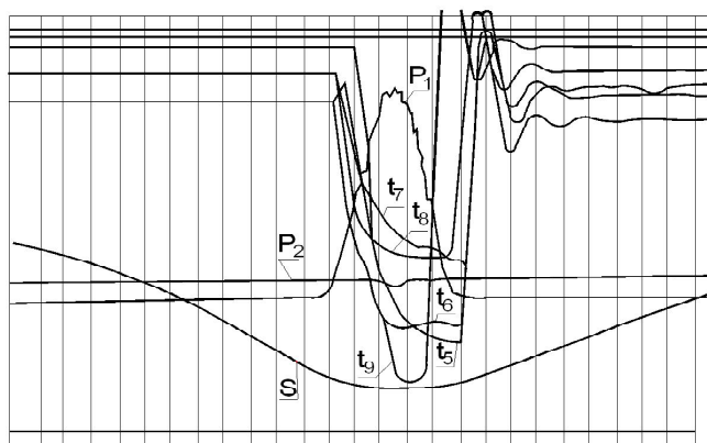
Рисунок 3. Осциллограмма контактных температур и усилий при горячей штамповке заготовок лопаток
