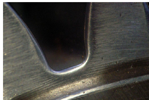
Рисунок 2. Кромка фаски исследуемого зубчатого колеса из стали 14ХНСН2МА под бинокулярным микроскопом
