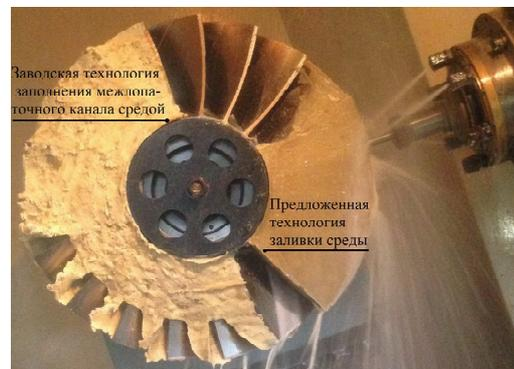
**Рис. 3.** Обработка первого уровня пера лопатки моноколеса ГТД при заполнении межлопаточного канала по технологии заливки
