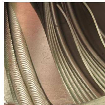
Рис. 9. Черновое фрезерование межлопаточного пространства ЦБК двумя методами
