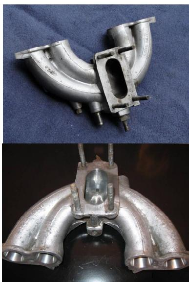
Рис. 1. Загальний вид впускного колектора карбюраторного чотирициліндрового двигуна
