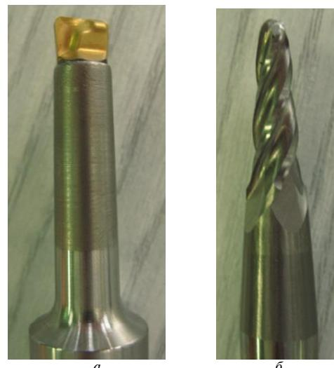
Рис. 10. Инструмент для плунжерного (а) и строчного (б) фрезерования
