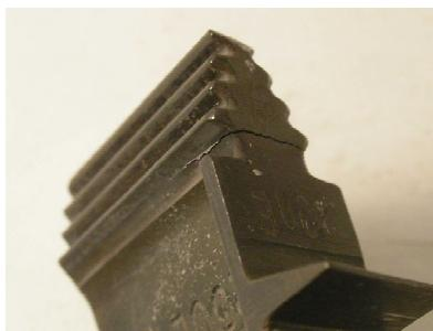
Рис. 1. Внешний вид трещины
