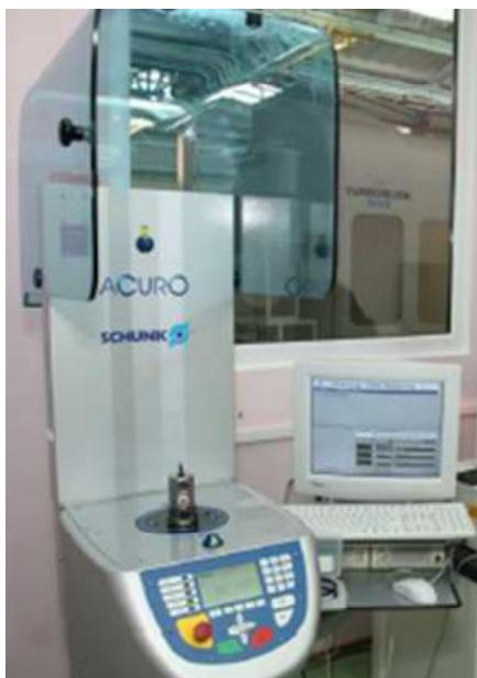
Рис. 1. Балансировочный станок Acuro фирмы Schunk
