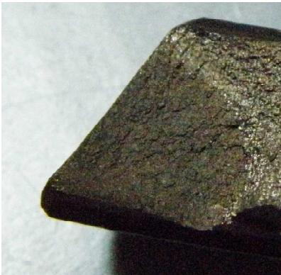
Рис. 4. Излом по трещине
