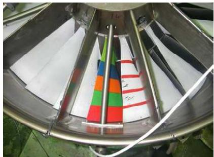
Рис. 5. Корпус двигателя с подготовленной лопаткой
