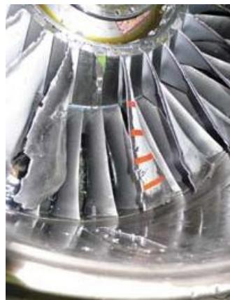
Рис. 7. Ротор вентилятора после испытаний
