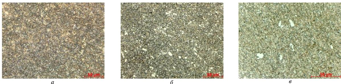
Рис. 5. Микроструктура образцов из жаропрочных сталей после азотирования с последующей закалкой ТВЧ:
