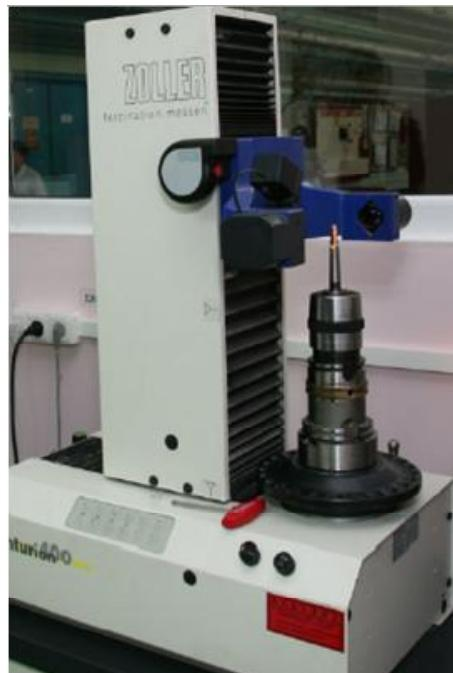
Рис. 2. Микроскоп Zoller для настройки осевого инструмента
