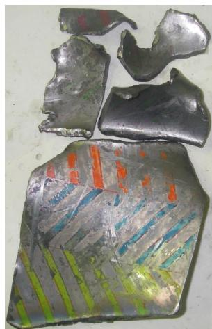
Рис. 8. Разрушенная лопатка после обрыва
