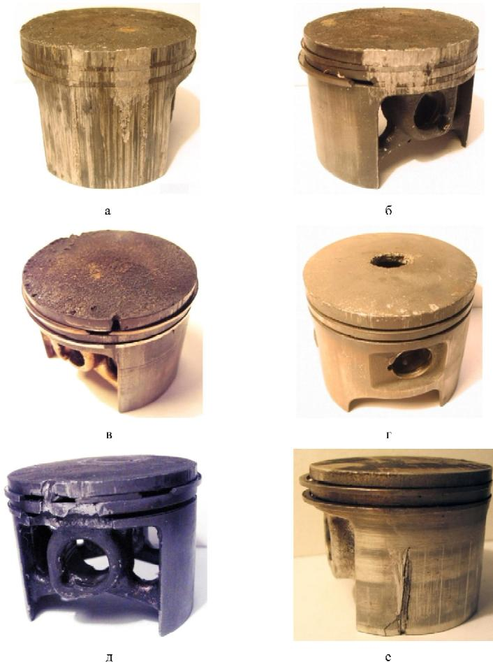
**Рис. 1. Основные виды повреждений поршней из сплава АЛ25:**
