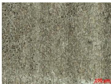
Рис. 3. Микроструктура образца из стали 40Х10С2М до обработки
