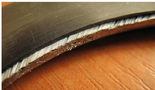
Рис. 1. Фотография щеточного уплотнения ГТД
