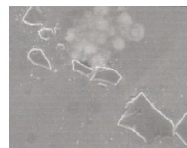
Рис. 22. Морфология карбидов на торце хвостовика (а, б) и сердцевине хвостовика (в, г) рабочей лопатки 7 ступени компрессора дв. Д-436: а, б –  $\times 2000$ ; в –  $\times 3500$
