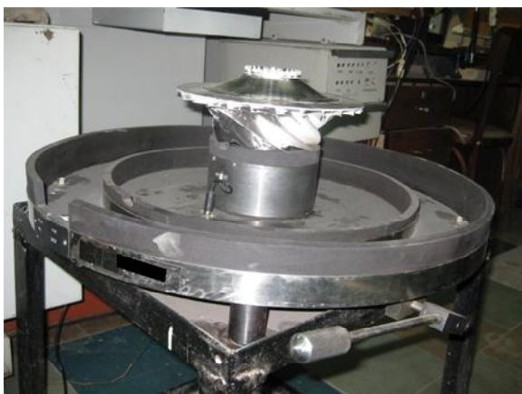
**Рис. 1.** Установка для збудження та демпфування лопаток
