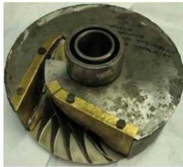
Рис. 4. Приспособление для упрочнения сектора моноколеса компрессора
