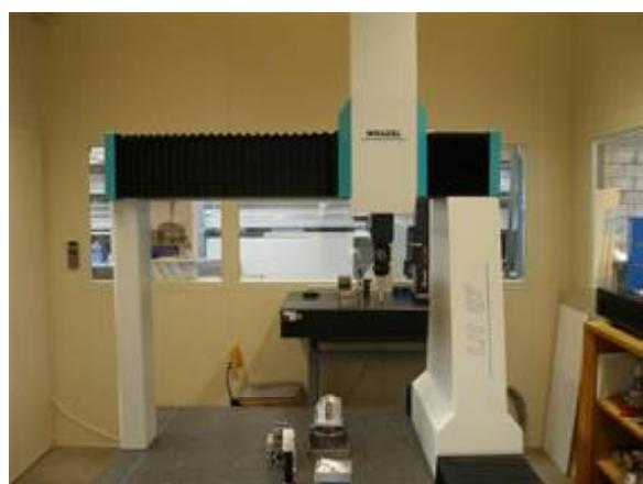
Рис. 3. Контрольно-вимірювальна машина Wenzel LH-87
