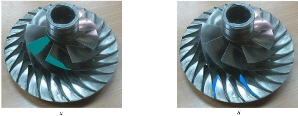
**Рис. 6.** Позначення місць знімання прошарку матеріалу при доведенні частот власних коливань:
