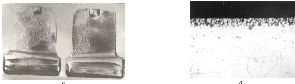
**Рис. 5.** Повышенная шероховатость профиля пера лопатки из сплава ЭП718-ИД со стороны спинки (*а*) и поверхностный полуокисленный слой (*б* —  $\times 500$ )
