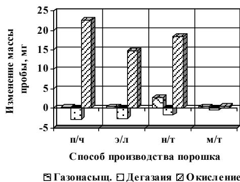
Рис. 7. Изменение массы пробы титанового порошка при нагреве в зависимости от способа его производства
