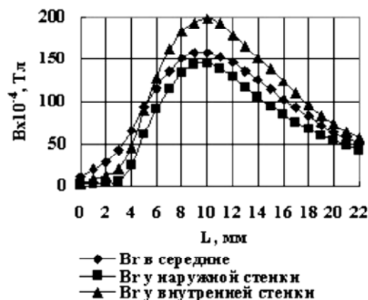
Рис. 2. Распределение магнитного поля по длине РК ( L = 12 мм – передний срез двигателя)
