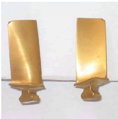
Рис. 1. Покрытие из TiZrN, нанесенное на лопатки компрессора вертолетного двигателя в вакууме плазменно-ионным методом
