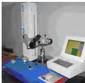
Рис. 17. Микроскоп TOOL MASTER 250 для настройки инструмента
