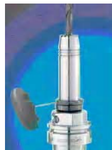
Рис. 19. Установка балансировочных колец
