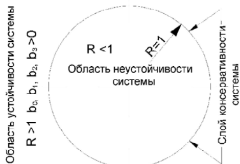
Рис. 2. Области параметров системы, обеспечивающие устойчивое, неустойчивое и консервативное поведение системы
