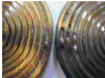
Рис. 3. Заплавления каналов на образцах
