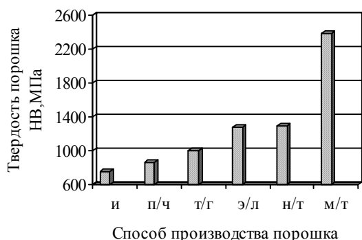
Рис. 2. Влияние способа производства на твердость титанового порошка
