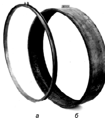
Рис. 1. Сварная кольцевая заготовка из профильного проката (а) и листа (б)
