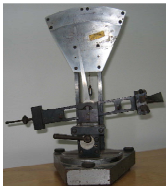
Рис. 1. Приспособление для определения статических моментов лопаток
