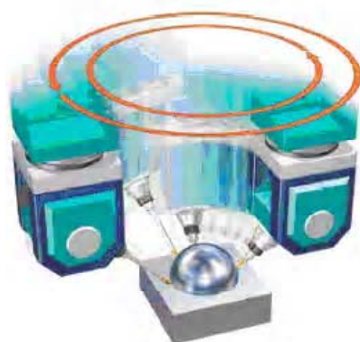
Рис. 8. Пятиосевая трансформация через функцию TRAORI
