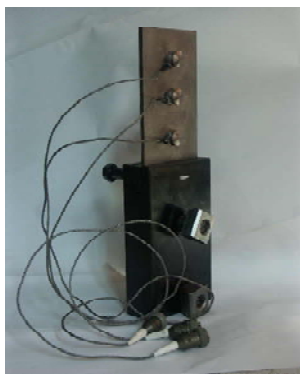
Рис. 3. Общий вид приспособления и пластины, препарированной вибродатчиками
