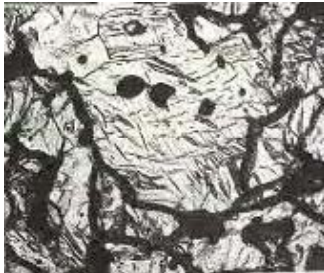
Рис. 5. Микроструктура прессованного образца из электролитического титанового порошка промышленного производства, \times 300
