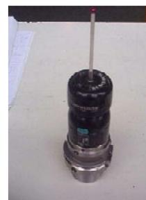
Рис. 19. Измерительный щуп "RENISHAW"
