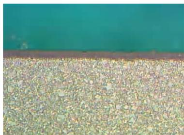
Рис. 4. Структура твёрдого сплава с PVD покрытием
