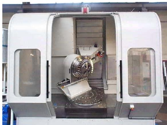
Рис. 11. Общий вид 5-ти координатного станка фирмы "LIECHTI" TURBOBLISK 1500
