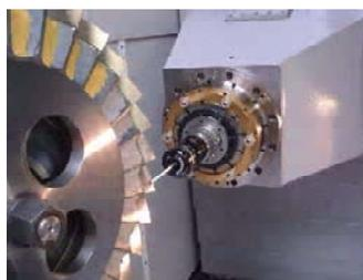
Рис. 18. Измерение профиля лопатки
