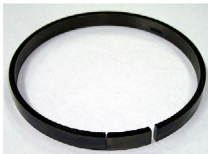
Рис. 1. Кольцо, вырезанное из втулки, и образец, вырезанный для исследования, разрезанный по образующей кольца
