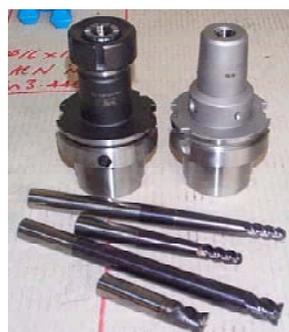
Рис. 17. Инструмент и гидрооправки фирмы SANDVIK
