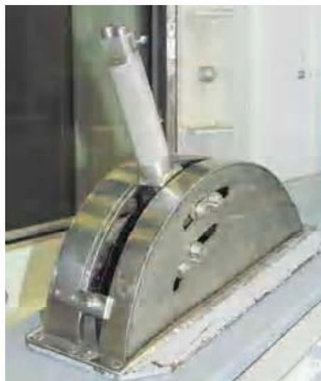
Рис. 6. Рычаг управления двигателем
