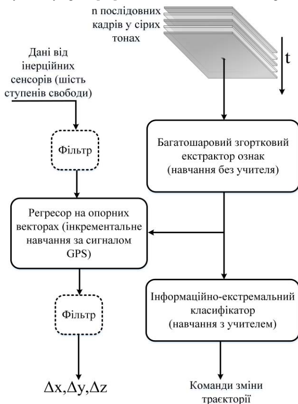
Рисунок 1 – Узагальнена схема інтелектуальної навігаційної системи малогабаритного БЛА
