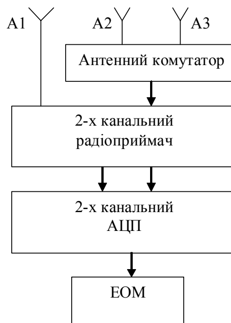
Рисунок 1 – Структурна схема досліджуваного пеленгатора
