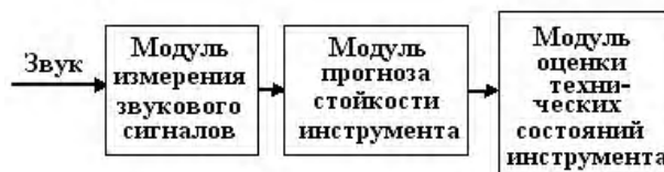
Рисунок 2 – Модули, из которых состоит программная часть
