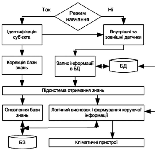
Рисунок 4 – Логіко-функціональна схема роботи експертної системи
