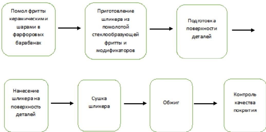
Рис. 1. Технологическая схема получения тугоплавкой эмали
