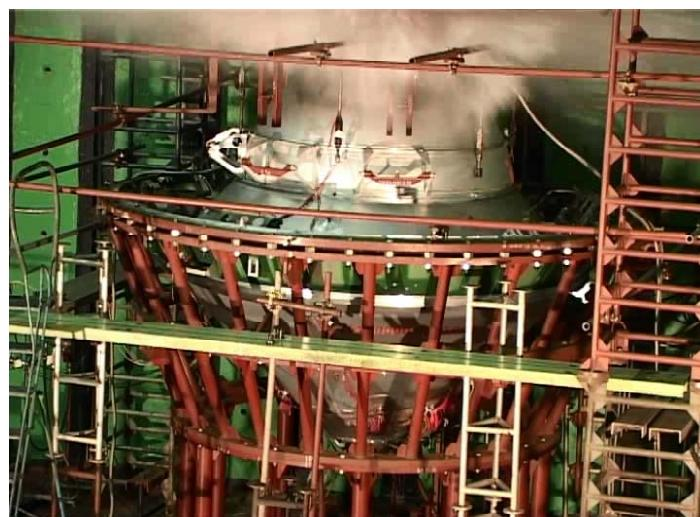
Рис. 7. Начало процеса розрушения ТО 3-й ступени
