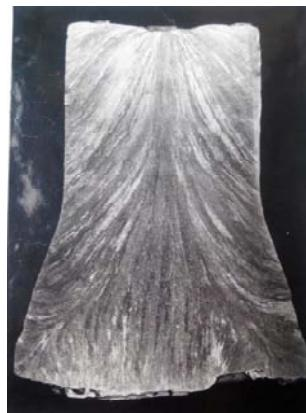
**Рис. 2.** Макроструктура заготовки запорного клапана из стали 08Х18Н10Т, полученного методом ЭШВ + ДП
