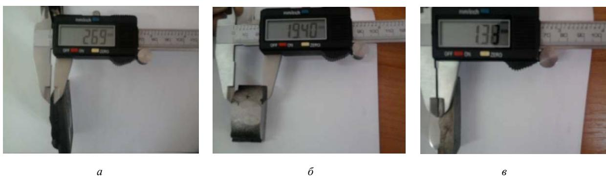
Рис. 2. Методика измерения высоты усиления (*a*), ширины шва (*б*), глубины проплавления (*в*)
