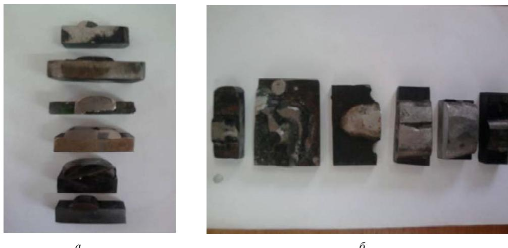
Рис. 1. Результаты наплавки экспериментальных образцов: *a* – в разрезе; *б* – вид сверху
