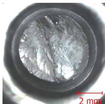
Рис. 3. Строение излома монокристаллического термообработанного образца, отлитого из сплава CMSX-4 PLUS производства фирмы «CANNON-MUSKEGON CORPORATION» после испытаний на растяжение при комнатной температуре, \times 10
