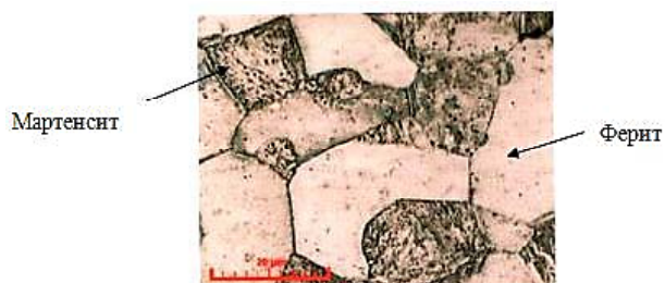
Рис. 1. Мікроструктура вихідних зразків сталі 06X18ч (збільшення \times 1000 )
