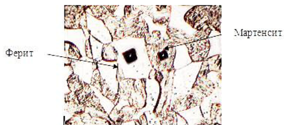
Рис. 2. Мікроструктура сталі 06X18ч після загартування \times 500
