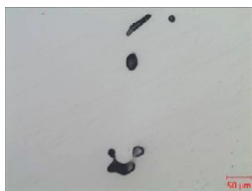
Рис. 9. Микропористость в образцах \varnothing 15 мм, отлитых из сплава CMSX-4 PLUS производства фирмы «CANNON-MUSKEGON CORPORATION» после термообработки
