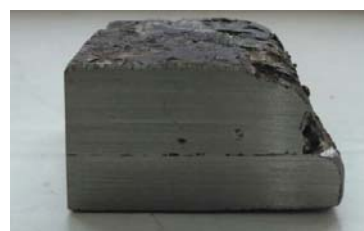
б – зразки наплавки понад 40 % металевого наповнювача в термітній шихті
