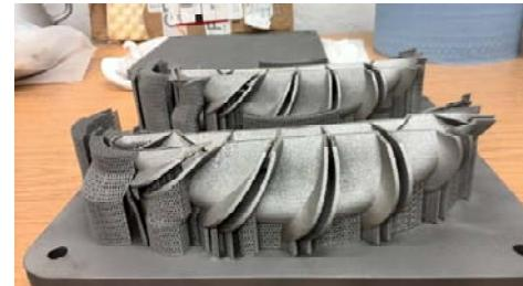
Рис. 9. Внешний вид диффузора компрессора, изготовленного по модели АО «Мотор Сич» на SLM Solutions
