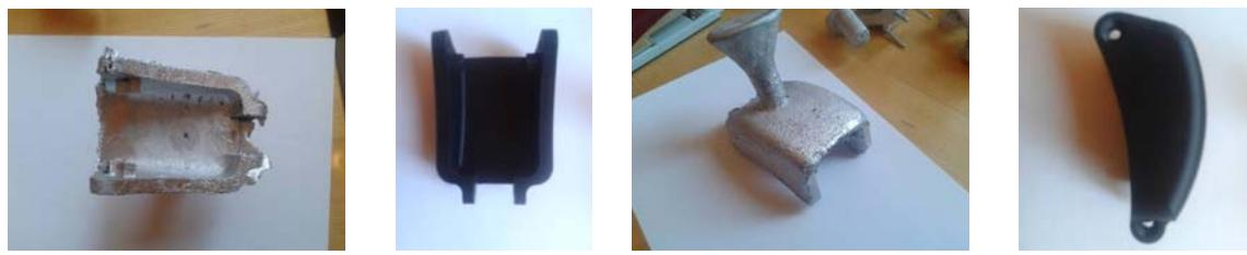
Рис. 15–18. Модель и отливка «Рычаг-2»
