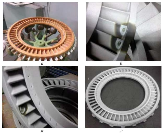
**Рис. 4.** Технологический процесс изготовления цельнолитого СА ТВ3-117 аппарата из спроектированного сплава ЖСЗЛС-М в условиях промышленного производства ЗМЗ им. В. И. Омельченко: а – внешний вид модельного блока; б – устранение литьевых точечных дефектов методом АДС; в – устранение микротрещин методом АДС; г – цельнолитой СА ТВ3-117 после устранения дефектов, ТО и ЛЮМ-контроля
