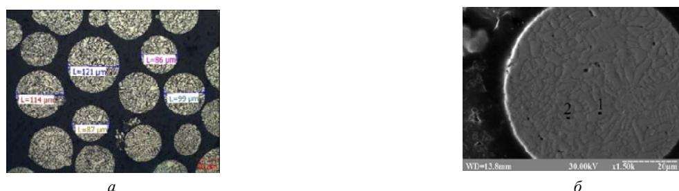
**Рис. 5.** Мікроструктура порошкового сплаву ЕП 741п (а – × 500; б – × 1500)
