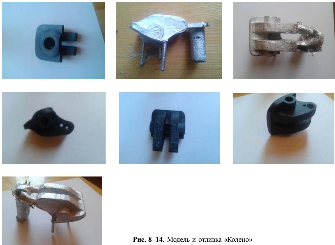
Рис. 8–14. Модель и отливка «Колено»
