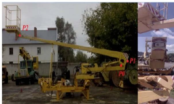
Рис. 5. Розташування датчиків на експериментальному АГП
