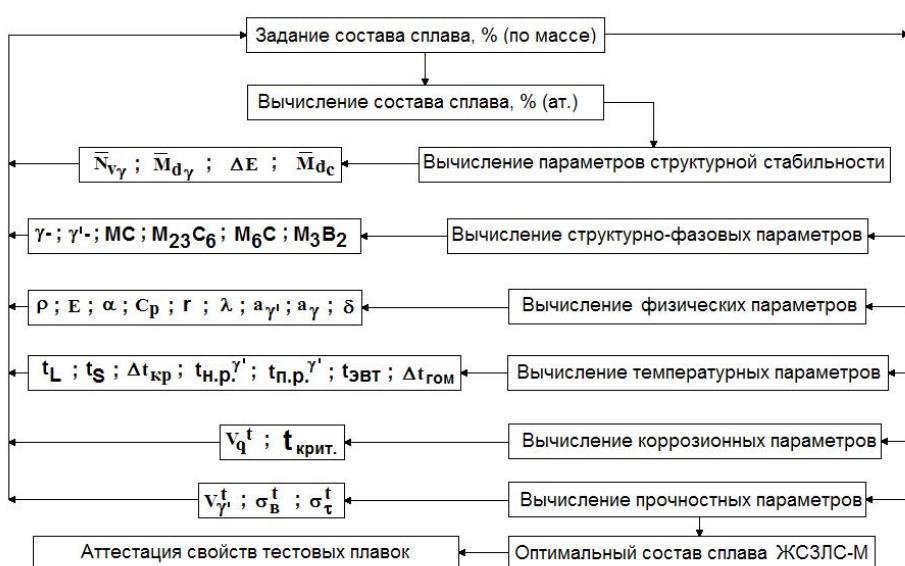
Рис. 1. Алгоритм компьютерного расчета проектируемого сплава ЖСЗЛС-М по разработанной методике КРАМ [12]
