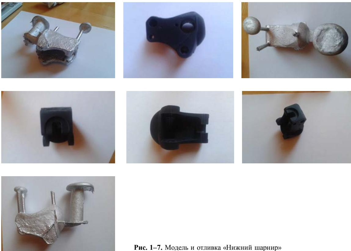
Рис. 1–7. Модель и отливка «Нижний шарнір»
