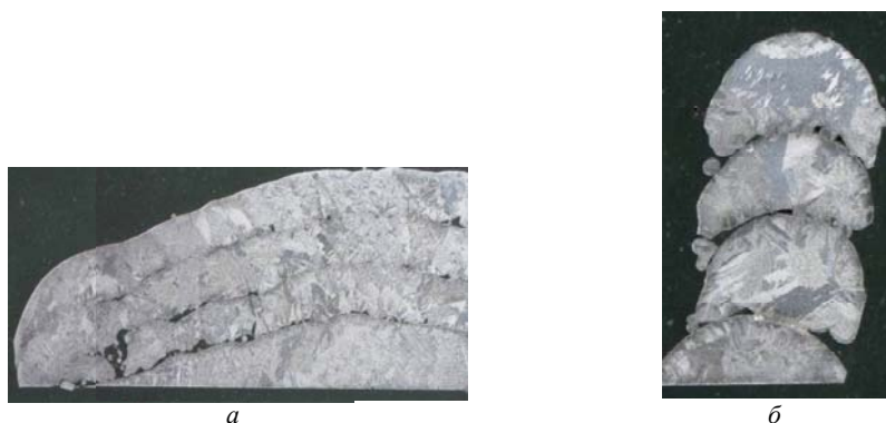
Рис. 6. Макроструктура полученных образцов: а – продольный шлиф, б – поперечный шлиф
