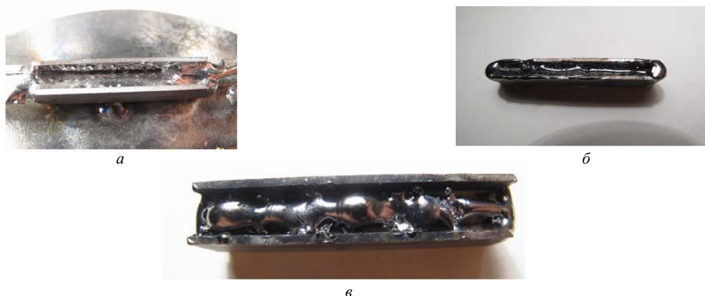
Рис. 1. Внешний вид опытных образцов, полученных с использованием порошка марки BT1-0 (фракция -0,63/+0,315 мм):
