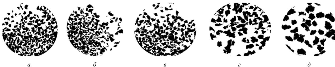
Рис. 3. Общий вид исследованных порошков титана (× 40): а – № 1; б – № 2; в – № 3; г – № 4; д – № 5
