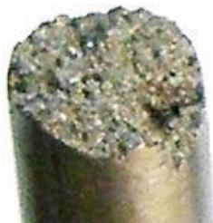
Рис. 8. Фрактография излома образца после испытания на растяжение
