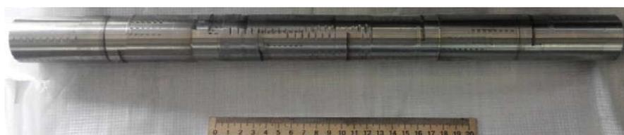
Рис. 4. Прутки  $\varnothing$  40 мм, полученные на основе метода порошковой металлургии и сварки
