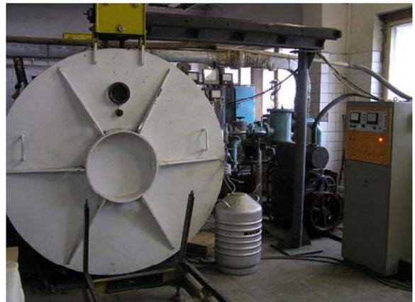
**Рис. 2.** Вакуумная электродуговая установка для реактивного нанесения покрытий TiN, ZrN, TiO, TiC
