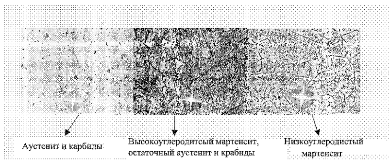
Рис. 4. Многослойная структура мартенситно-стареющей стали 03Н24ТЮ × 800
