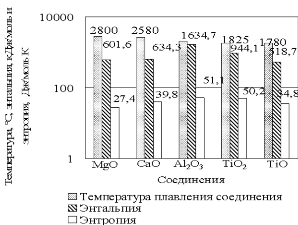
Рис. 1. Температуры плавления, энтальпии и энтропии образования карбидов (а), нитридов (б), оксидов (е) и сульфидов (z) (полулогарифмическая шкала)
