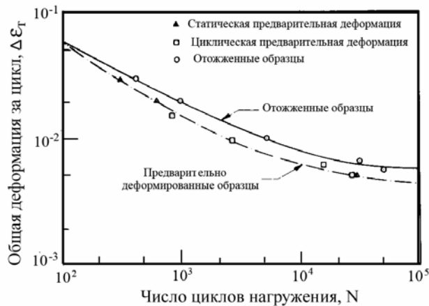
Рис. 1. Кривые малоцикловоу усталости технически чистого титана [19]
