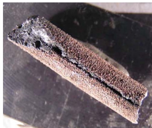
Рис. 1. Вид проволоки из стали 03X22Ю5ФБч после выхода нагревателей из строя
