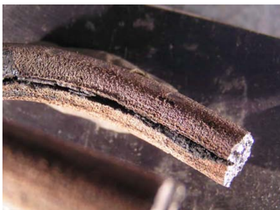
Рис. 1. Вид проволоки из стали 03X22Ю5ФБч после выхода нагревателей из строя
