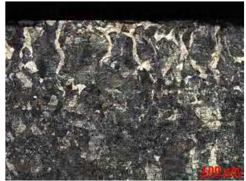
Рис. 6. Микроструктура силицированной стали ШЧ15СГ, \times 200
