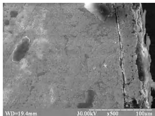
Рис. 8. Фотографии силицированной стали ШХ15СГ, полученные на растровом микроскопе РЭМ 106 У во вторичных электронах, \times 500 и \times 2000
