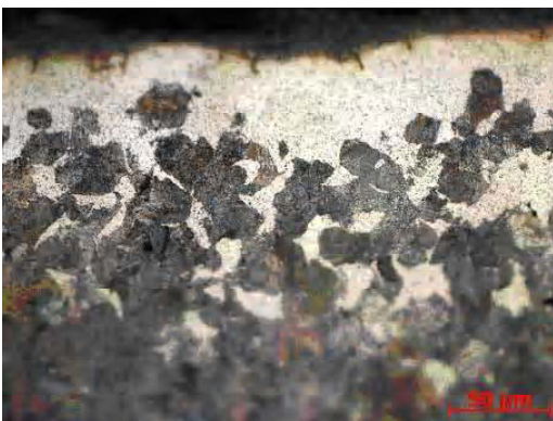
Рис. 5. Микроструктура силицированной стали ШХ15 × 500 и × 1250
