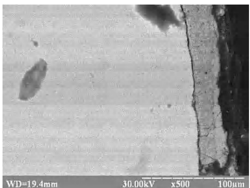
Рис. 9. Фотографии силицированной стали ШХ15СГ, полученные на растровом микроскопе РЭМ 106 У в отраженных электронах, \times 500 и \times 1000
