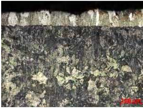
Рис. 6. Микроструктура силицированной стали ШЧ15СГ, \times 200
