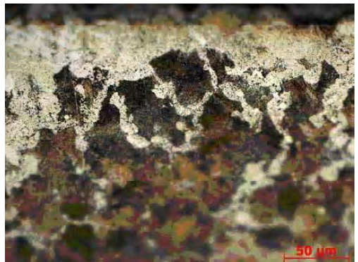
Рис. 7. Микроструктура силицированной стали ШЧ20СГ, \times 100 и \times 500
