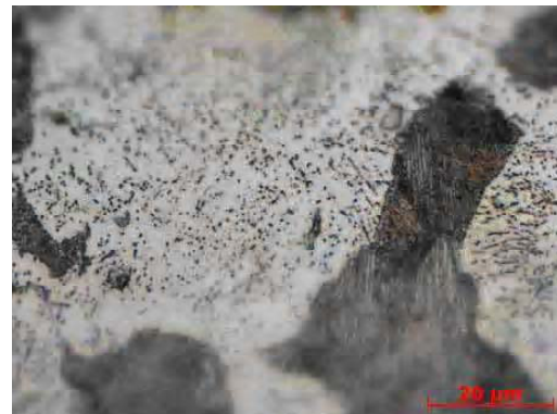
Рис. 5. Микроструктура силицированной стали ШХ15 × 500 и × 1250
