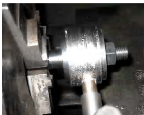
Рис. 2. Образец шейки чугуна ВЧ50 закрепленный на оправке, установленный в бабке токарного станка, с адгезионной средой на поверхности (Ga-88 %, In-10 %, Cu-2 %) в контакте с инструментом-цилиндром (BrOF4-0,25)
