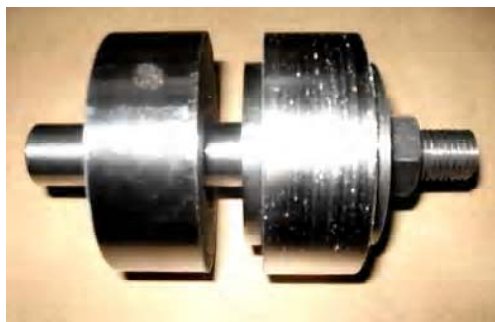
Рис. 1. Образцы шеек коленчатых валов на оправке: слева образец сталь 45 без покрытия; справа образец сталь 45 материалом адгезионной среды (Ga-88 %, In-10 %, Cu-2 %)
