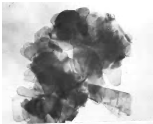
Рис. 3. Микроструктура частицы шихты композита после 40 мин механо-химической обработки
