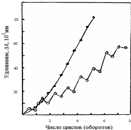
Рис. 1. Изменение длины образца при одностороннем кручении (●) и циклической деформации (○) с амплитудой 360^\circ
