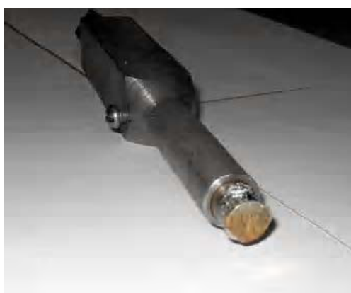
Рис. 3. Устройство для фрикционно-механического нанесения антифрикционных покрытий: на переднем плане рабочая поверхность инструмента-цилиндра (BrOF4-0,25) со следами адгезионной среды (Ga-88 %, In-10 %, Cu-2 %) в верхней части
