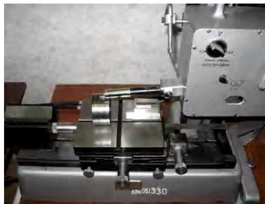
Рис. 5. Снятие профилограммы поверхности образца шейки на профилографе «Калибр-201»
