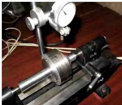
Рис. 4. Измерения микротклонения формы поверхности образца шейки: в центрах на оправке установлен образец сталь 45 с медьсодержащим покрытием
