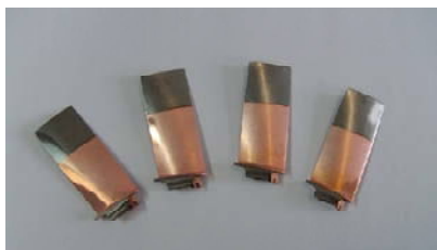
Рис. 1. Лопатки с покрытием наноструктурированной медью
