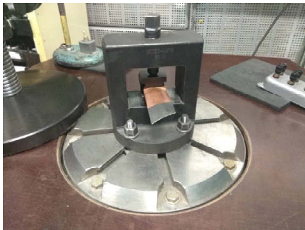
Рис. 2. Лопатка с покрытием из меди, закрепленная на стенде ВЭДС-400
