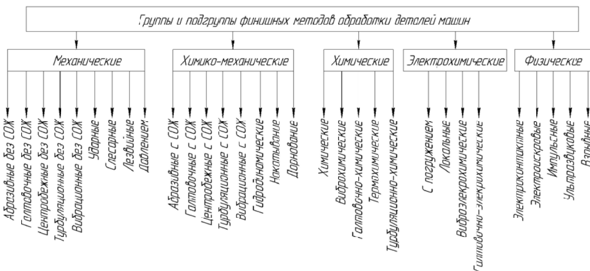
Рис. 1. Классификация методов финишной обработки
