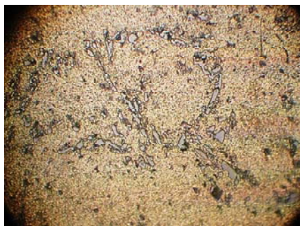
Рис. 2. Структура сплава АК5М (АЛ15), \times 500 : а – заводська технологія; б – експериментальна
