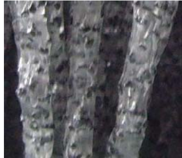
Рис. 1. Волокна полимерно-абразивного инструмента
