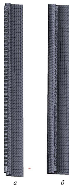
Рис. 2. Конечно-элементная сетка многослойного контейнера: а – внутренняя и средняя втулки; б – средняя и внешняя втулки
