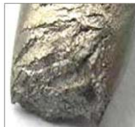
Рис. 1. Влияние способа введения кислорода на характер разрушения образцов титана типа ВТ1-0:
