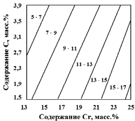
Рис. 2. Зависимость содержания хрома в основе от содержания Cr и C в чугуне при 3,0% Mn и 1,6% Ni
