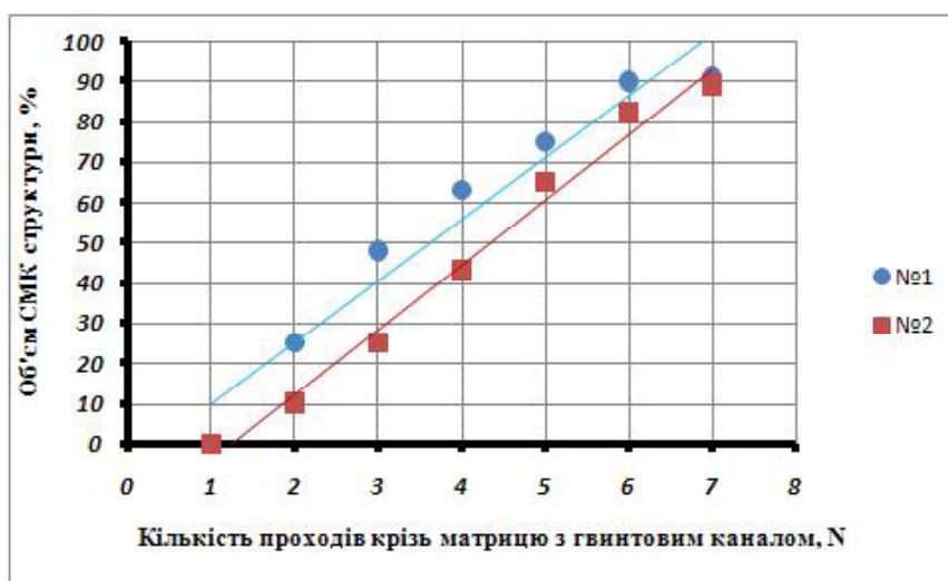
Рис. 2. Вплив кількості проходів крізь матрицю з гвинтовим каналом на кількість СМК зерен розміром менше за 500 мкм в структурі титанових сплавів дослідних складів № 1 і № 2: 1 – сплави складу №1 з рівноважною вихідною структурою; 2 – сплави складу №2 з пластинчастою вихідною структурою
