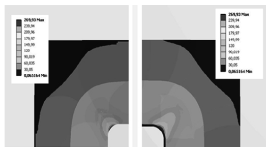
Рис. 6. Распределение эквивалентных напряжений по Мизессу (МПа) в нижней базовой плите: вид сверху (слева) и снизу (справа)
