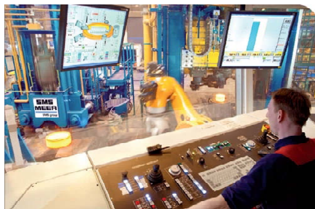
Рис. 9. Пульт управления установки для прокатки колец на заводе Hofors (Швеция)
