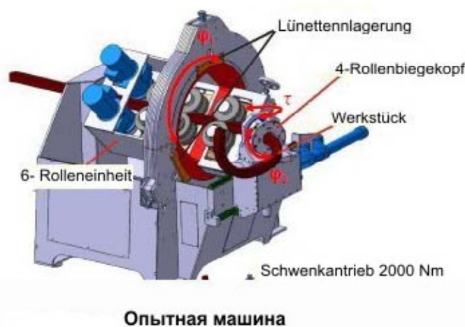
Рис. 3. Машина для трехмерной гибки профилей: Vorschubrolle – роликовая система подачи; Biegekopf – изгибающая головка; Biegeachse – ось изгиба; Schwenkachse – поворотная ось
