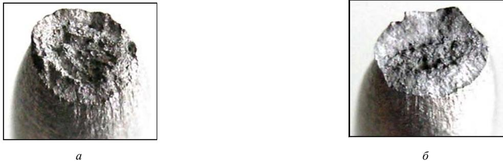
Рис. 8. Поверхности разрушения образцов из сплава ВТ1-0, вырезанных из прутка:
