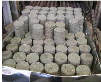
Рис. 3. Сушка брикетов в нагревательной печи
