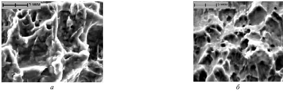
**Рис. 10.** Поверхность разрушения разрывных образцов из сплава ВТ1-0:
