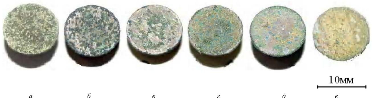
Рис. 1. Внешний вид монокристаллических образцов опытных составов, испытанных с нанесением на поверхность расплава  $\text{Na}_2\text{SO}_4$  при  $t = 950^\circ\text{C}$  в течение 50 часов:
