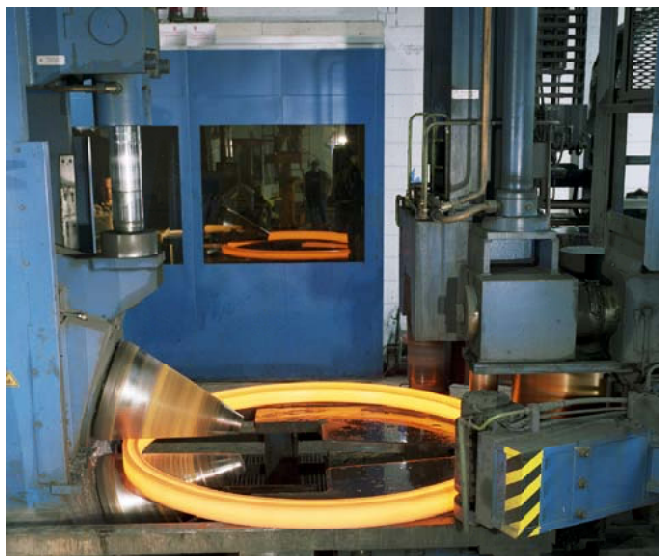
Рис. 4. Радиально-аксиальный кольцепрокатный стан
