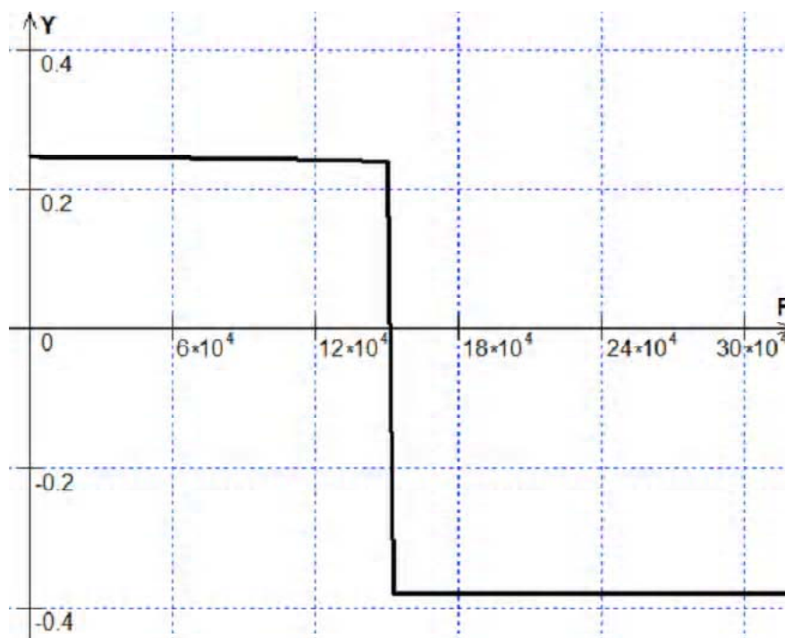
Рис. 5. Залежність вертикального переміщення вузла O від прикладеної сили P
