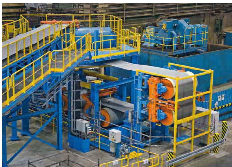
Рис. 7. Движущийся накопитель между линиями травления и холодной прокатки
