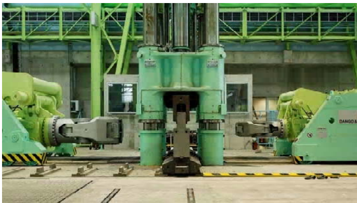
Рис. 5. Гидравлический ковочный пресс 5000
