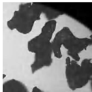
Рис. 1. Вид частиц порошка, имеющих дендритную форму
