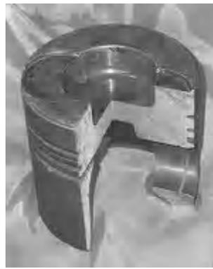
Рис. 7. Штампованный поршень КАМАЗ 740 после стендовых испытаний
