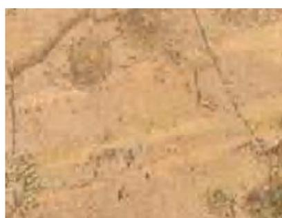
**Рис. 5.** Неравномерное выделение вторичной интерметаллидной фазы в образце из сплава Мл-10 после длительной выдержки (1252 часа,  $\sigma_{\delta} = 80$  МПа) при температуре 150 °С,  $\times 750$
