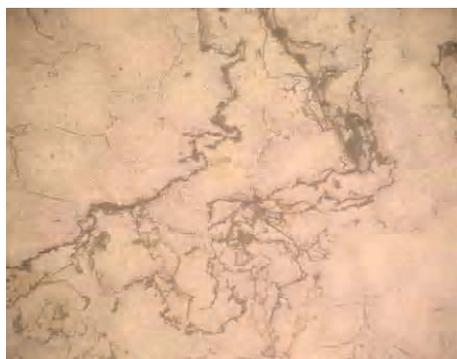
Рис. 1. Грубые плены в образцах из сплава Мл-10 с присадкой 1,0 % Sc,  $\times 100$
