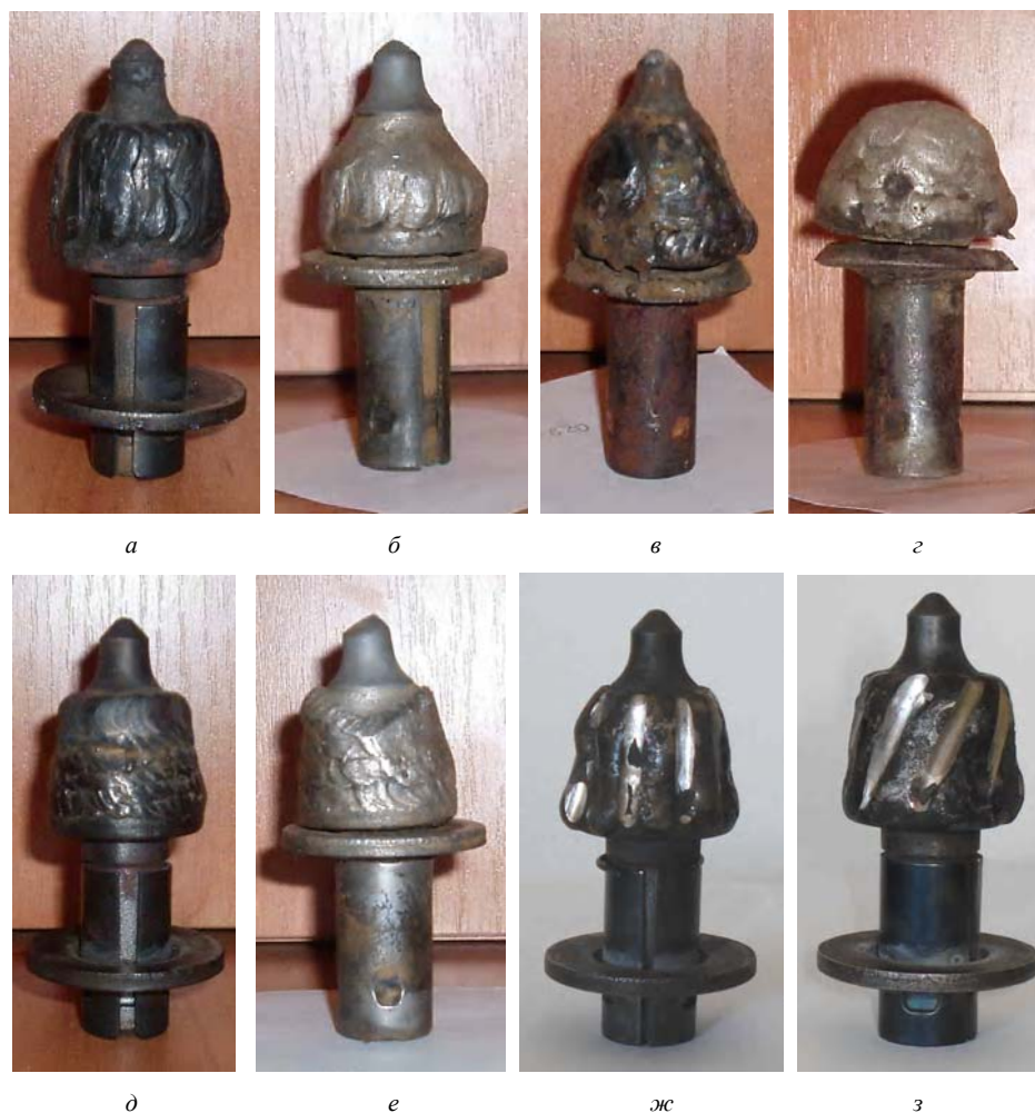
Рис. 9. Исследуемые резцы: наплавленный параллельно оси резца ОЗН-400 (а) и характер износа после выработки 3500 кв.м. (б); наплавленный параллельно оси резца Т-620 (в) и характер износа после выработки 3500 кв.м. (г); наплавленный по спирали Рэлит-ТЗ (д) и характер износа (е); наплавленный параллельно оси резца с зазорами (ж); наплавленный под углом к оси резца (з)
