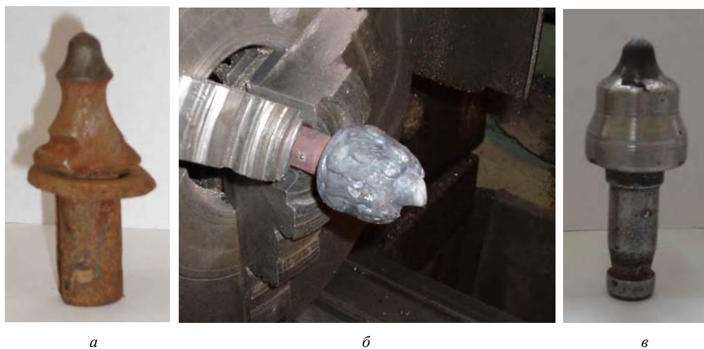
Рис. 3. Восстановление исходной геометрической формы ( б ) после наплавки изношенного резца ( а ), а также вид резца после токарной обработки ( в )
