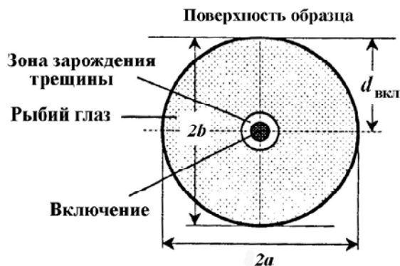
Рис. 5. Схема зарождения подповерхностной усталостной трещины у неметаллического включения
