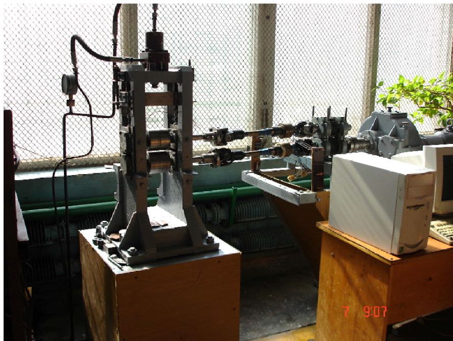
Рис. 2. Общий вид оборудования лабораторного прокатного мини-стана 100×100 Г Донбасской государственной машиностроительной академии
