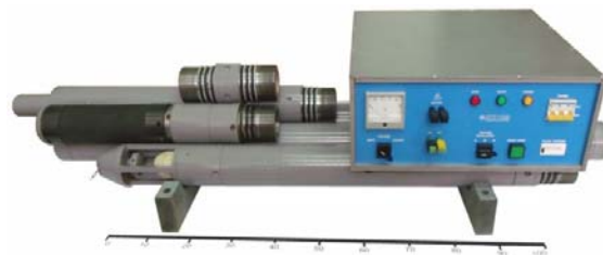
Рисунок 6. Электроразрядное погружное устройство «Скиф-100М»
