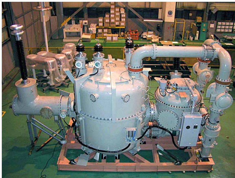
Фото 8. Силовой трансформатор 20 МВА, 154 кВ, заполненный элегазом под давлением
