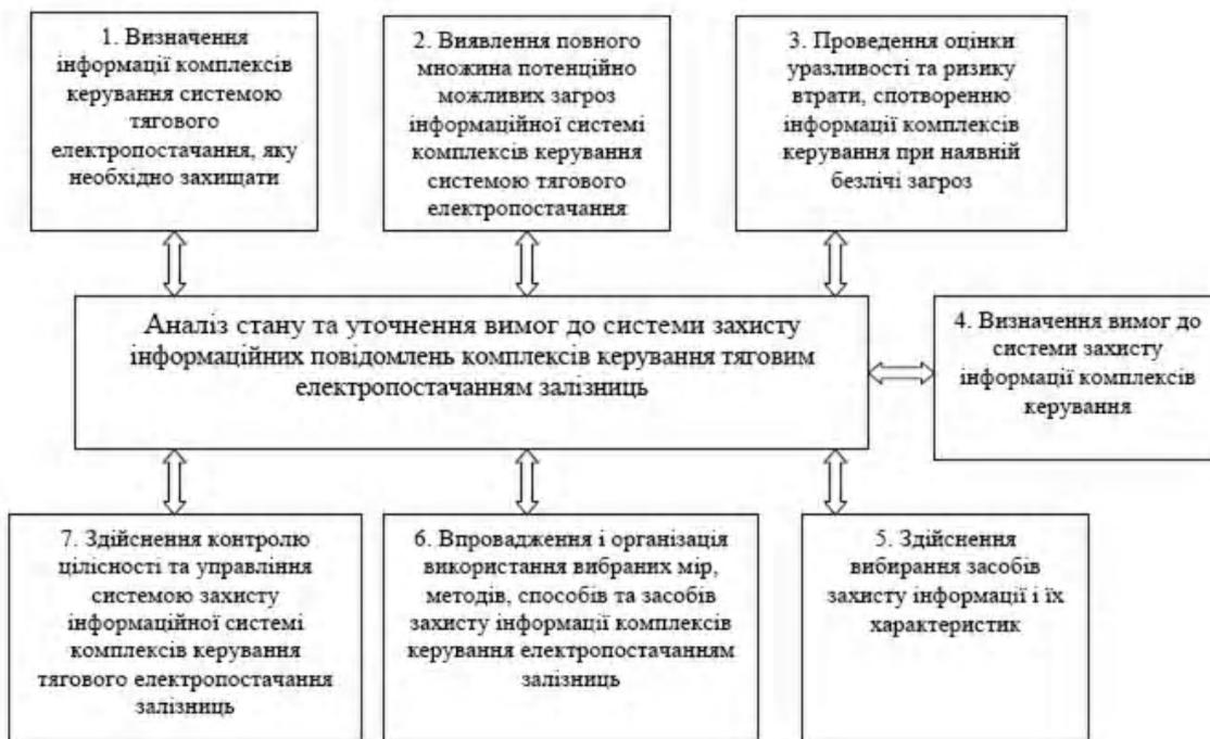
Рис. 1. Безперервний цикл створення системи захисту інформації комплексів керування тягового електропостачання залізниць
