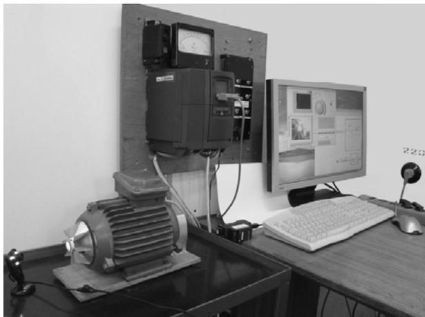
Рис. 1. Лабораторний стенд на основі перетворювача частоти MICROMASTER 440
