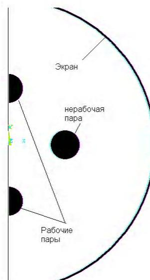
Рис. 1. Геометрическая двумерная модель половины кабеля
